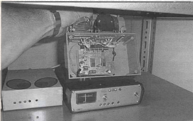
Foto 2 - Mux ad alimentazione singola, con il classico NE555, assieme ai TNC2 che controlla, un 1200 baud AFSK (con gli occhi) mentre l'altro è dotato di modem PSK, sempre a 1200 baud.
